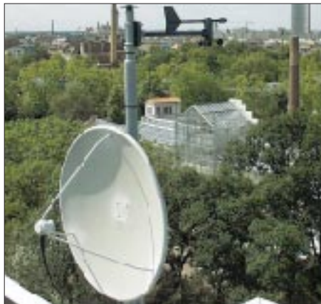
DB0EXP: 60-cm-Spiegel der Linkverbindung zu DB0LPZ und Anemometer der Wetterstation.
