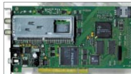
Bild 4: PC-seitig wird für den Empfangskanal vom Satelliten zum Anwender eine zusätzliche Einsteckkarte benötigt.
